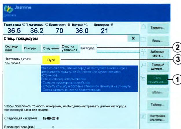
Рис. 53 Настройка датчиков O 2
