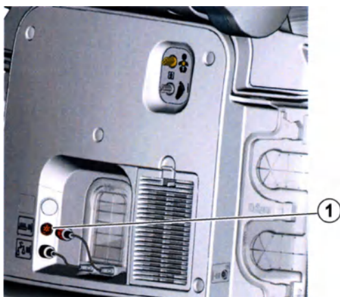
Рис. 54 Подключение матраса с подогревом
