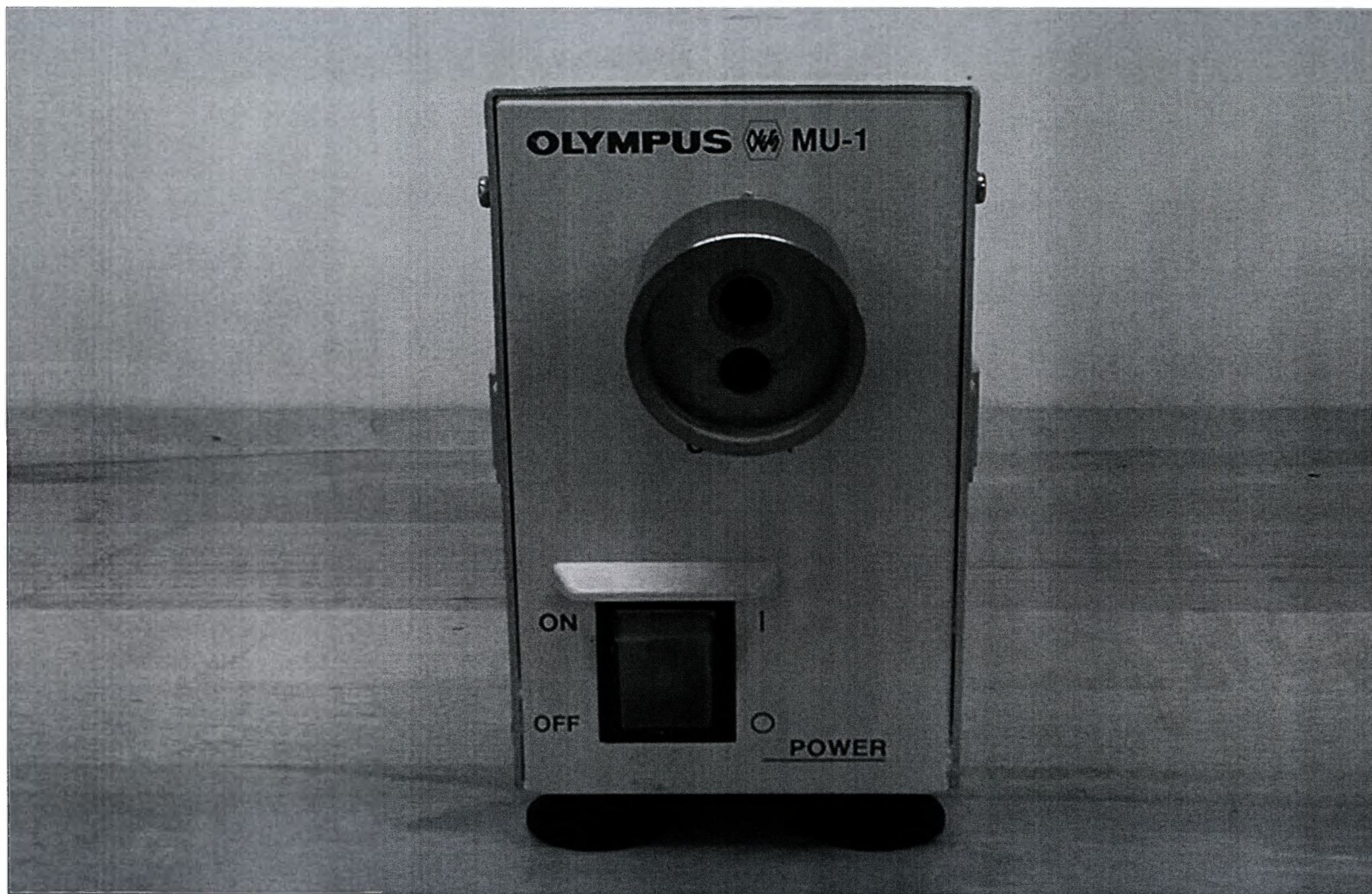
Устройство для проверки эндоскопов на герметичность MU-1
