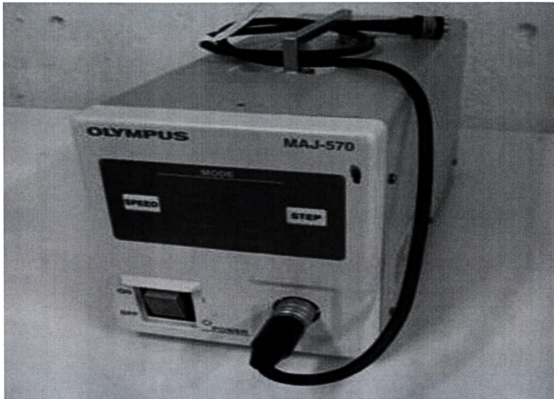
Блок увеличения MAJ-570 для эндоскопа, стандартная комплектация:
