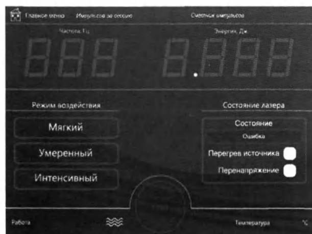
Рисунок 50 Неисправность источника питания
