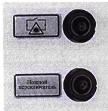
Рисунок 10 Подключение педали и блокирующего устройства
