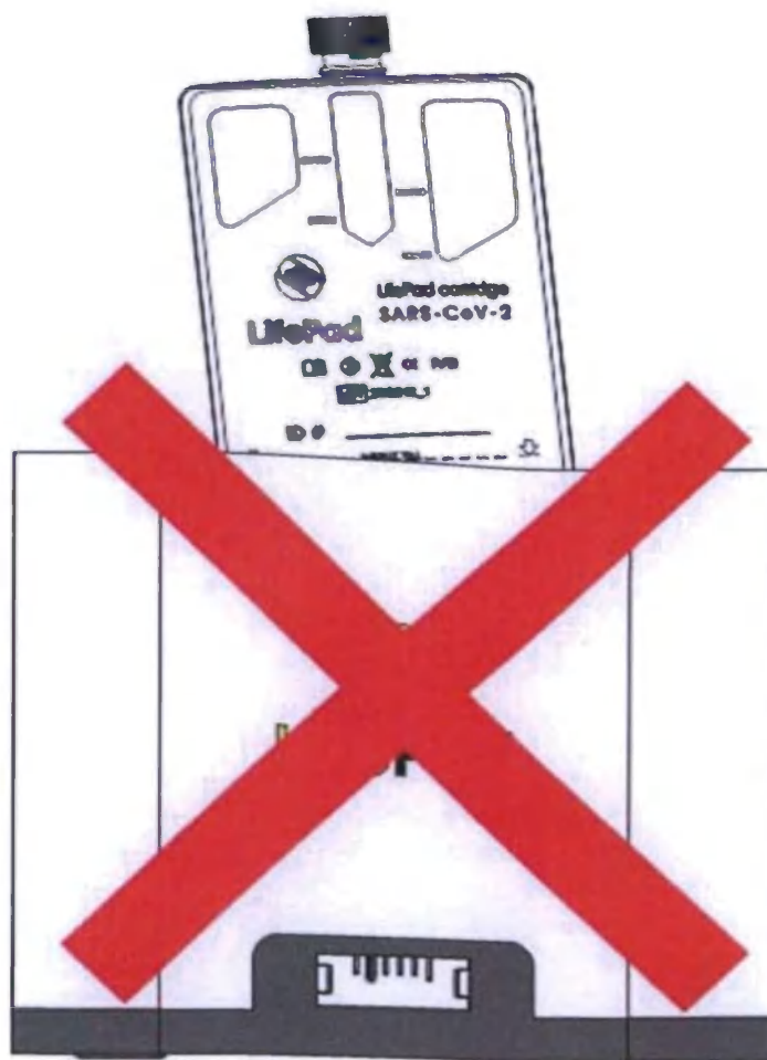
Рисунок 21. Схема неправильной установки Картриджа в устройстве
