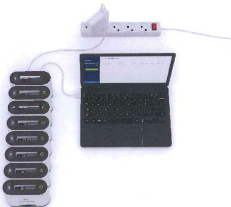
Рисунок 10. Вариант подключения Анализаторов в кластере из восьми приборов
