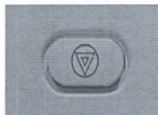
Рис. 3-28 Кнопки аварийной остановки на гентри
