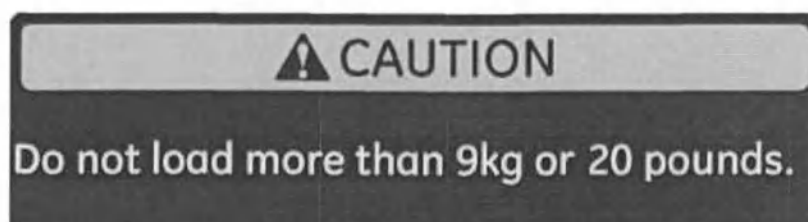
Рис. 3-27 Пределы нагрузки на лоток
