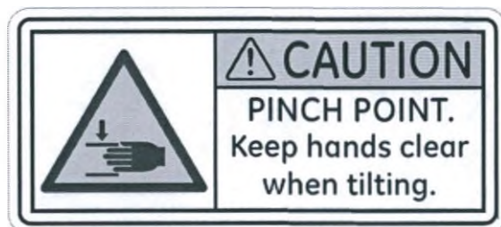
Рис. 3-8 Предупредительная этикетка внизу на левой боковой поверхности и внизу справа на передней и задней крышках гентри
