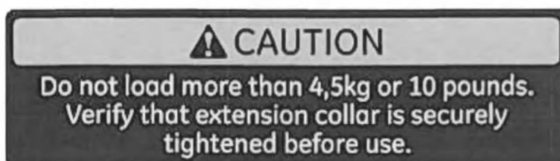
Рис. 3-26 Пределы нагрузки на стойку IV
