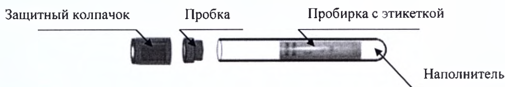
Рисунок 1. Пробирка вакуумная, конструкция
