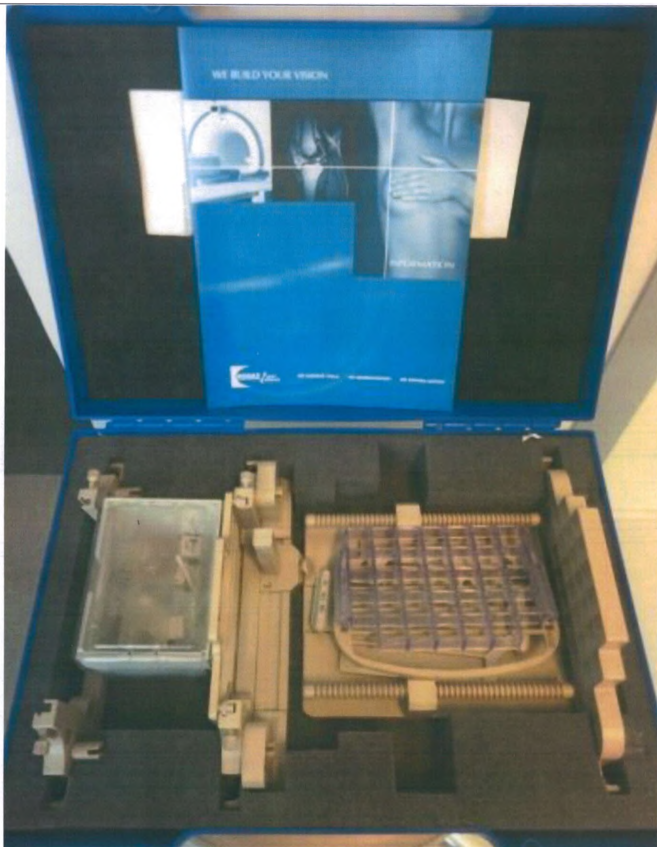
18. Набор тестовый для проведения биопсии молочных желез: - Пластина для введения (при медиальном доступе); - Горизонтальные и вертикальные пластины-перекладки; - Направляющая иглы (метод Post&Pillar); - Регулируемая по высоте решетка (многоуровневая); - Многоуровневая решетка (при необходимости); - Регулируемая по высоте решетка (одноуровневая); - Крепежная деталь рамы
