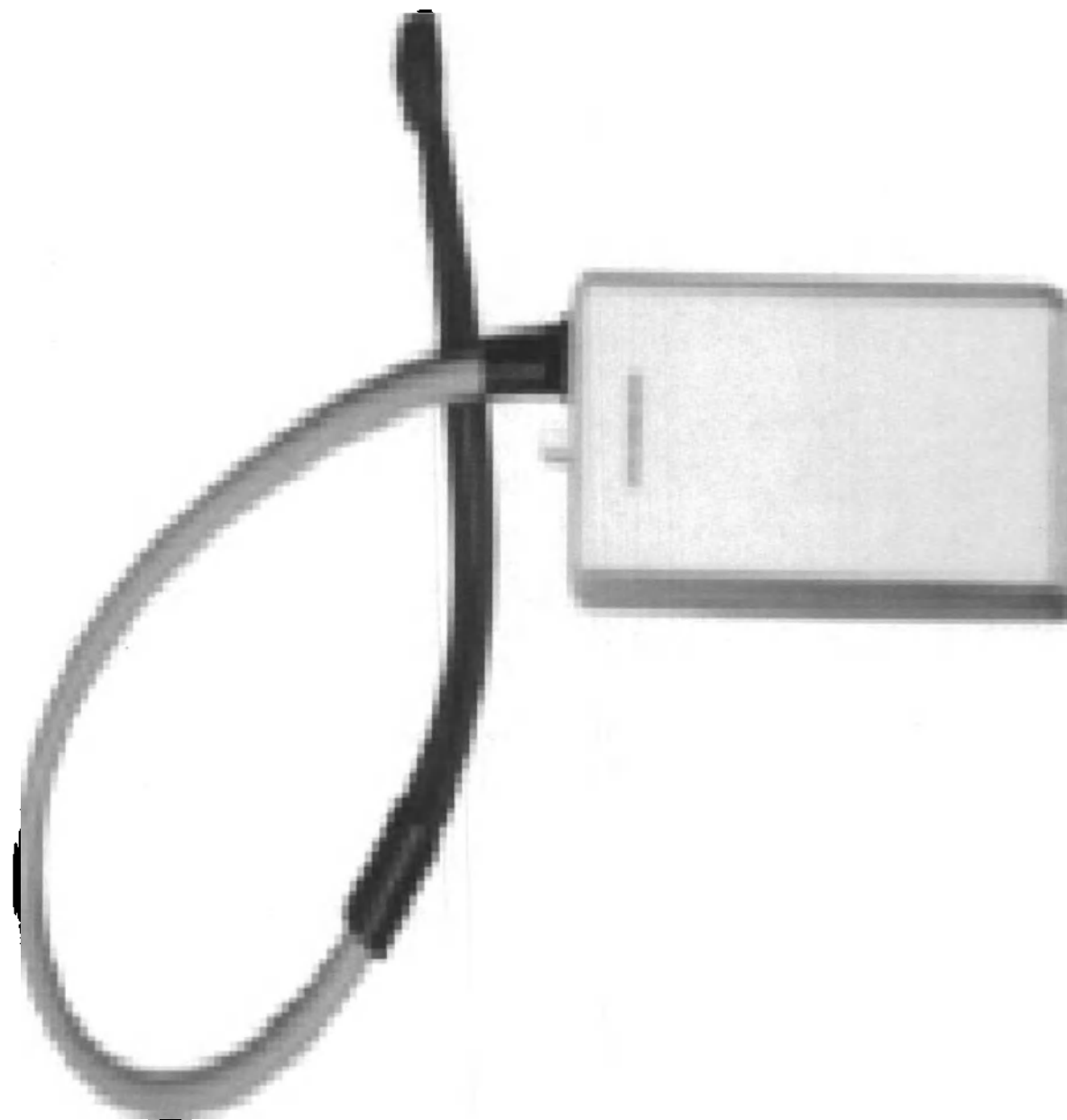
50.2. Блок для измерения физиологических параметров, в составе: - датчик ЭКГ; - датчик дыхания; - датчик пульса; - вход внешнего сигнала запуска.
