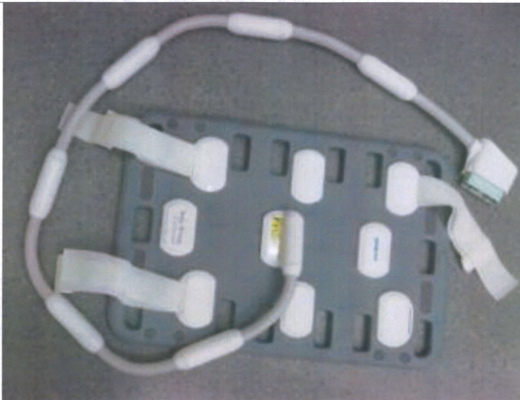
21. Кабели дополнительные для подключения катушек
