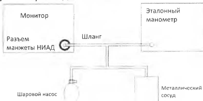
Рисунок 9.4 – Схема соединения манжеты НИАД с эталонным манометром.
