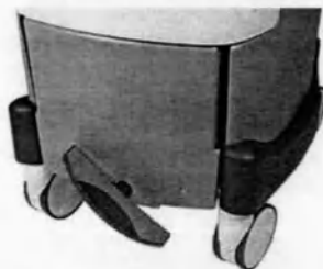
Рисунок 3-2: Передние колеса в заблокированном положении
