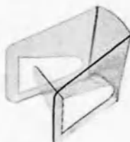
Рисунок 10-10: Ограждение от разбрызгивания жидкости, сложенное в местах перфорации
