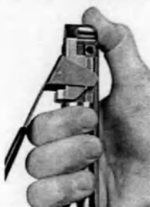
Рисунок 10-4: Нажатие на клещи для закрытия
