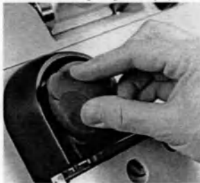
Рисунок 8-1: Извлечение ротора из корпуса насоса
