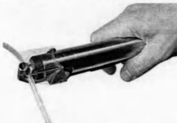
Рисунок 10-2: Держите бранши сомкнутыми пока не загорится индикатор.
