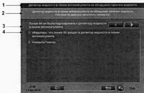
Рисунок 7-2: Пример экрана действий при сигнале тревоги
