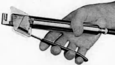
Рисунок 10-1: Возьмите запаиватель браншами вверх.
