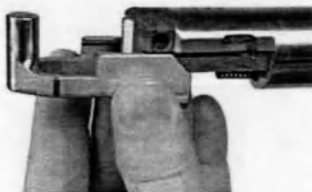
Рисунок 10-7: Совмещение клещей с выемками
