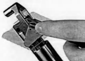
Рисунок 10-11: Установка и фиксация ограждения от разбрызгивания жидкости
