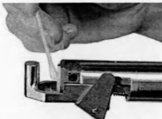
Рисунок 10-3: Очистите бранши ватным тампоном.
