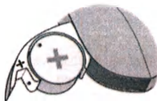
Рисунок 9 – Установка (замена) элемента питания СА «Tango»
