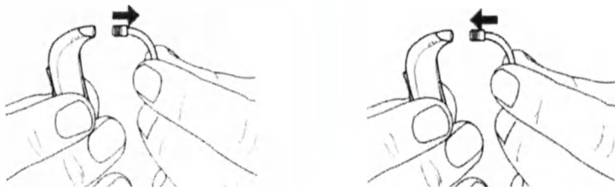
Рисунок 31 – Замена тонкой трубочки Corda2
