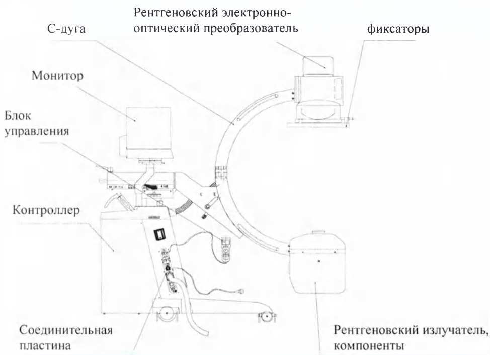
Рис.1. Основная конструкция установки
