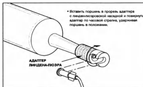
Рисунок 4-6 Крепление катетера или каниюлы к шприцам 125 мл и 200 мл
