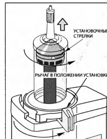
Рисунок 5-20 Снятие шприца 200 мл с передним заполнением
