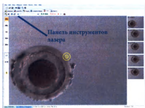
Рис.12: EyeWare страница «Видео» с «Панелью инструментов лазера» и «Перекрестьем» для прицеливания лазера
