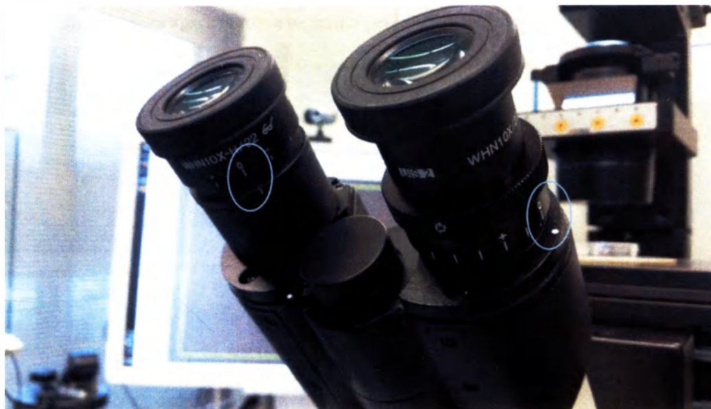
Рис. 56: Регулировка диоптров (пример: инвертированный микроскоп Olympus)
