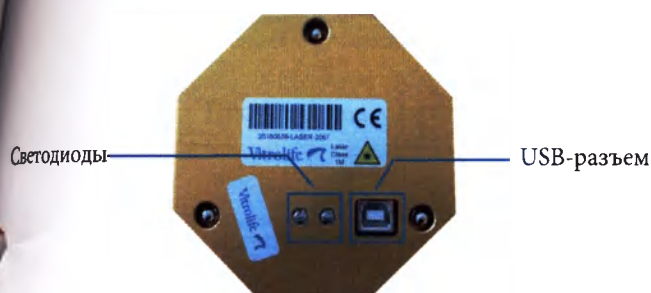
Рис. 5: Модуль лазерный с детальным представлением светодиодов состояния и USB-разъема
