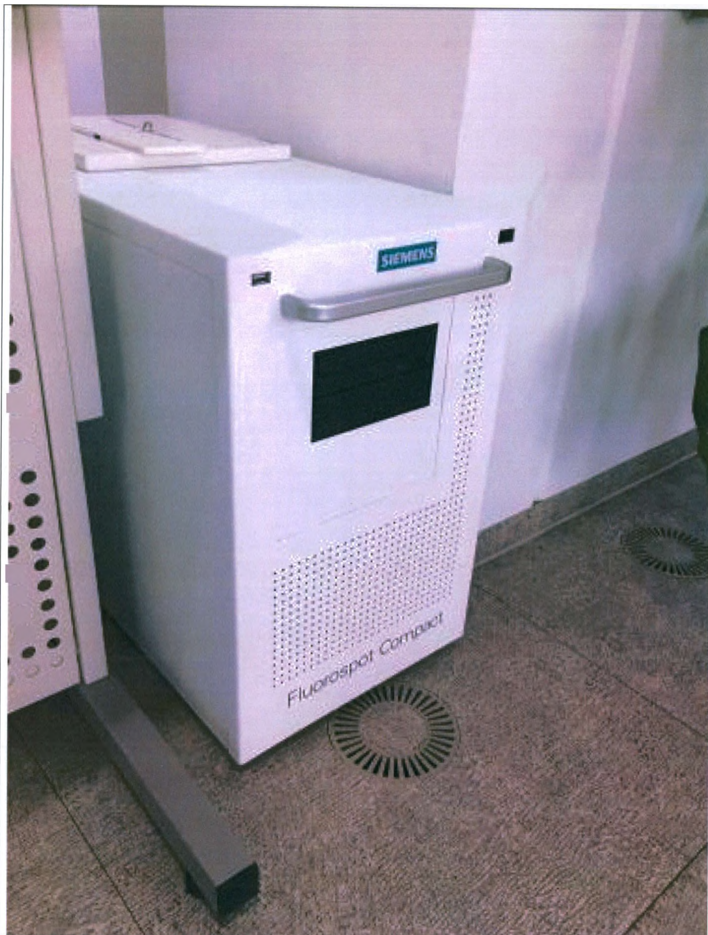
7. Система формирования изображений FLUOROSPOT Compact с базовым программным обеспечением, мышью и клавиатурой.
