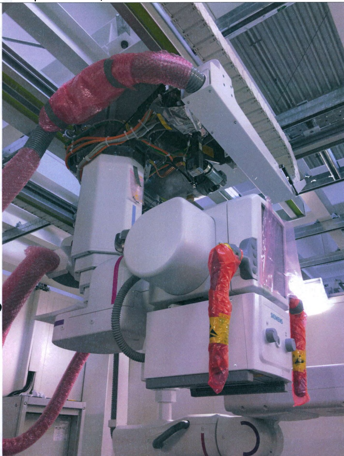
1. Потолочный штатив с блоком рентгеновской трубки, многолепестковым коллиматором и сенсорным интерфейсом
