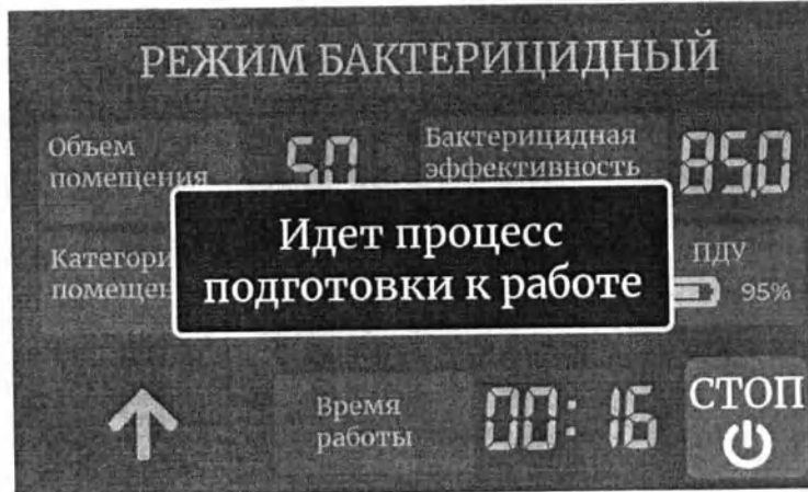
Рисунок 23—Экран панели управления. Включение режима УФ излучения
