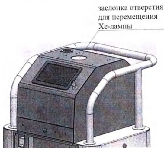
Рисунок 10 – Заслонка отверстия для перемещения Хе-лампы
