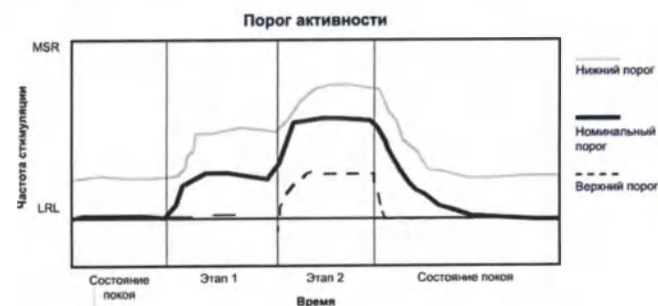
Рисунок 4–15. Порог активности и отклик частоты
