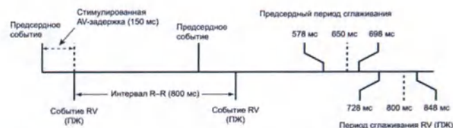
Рисунок 4–37. Период синхронизации сглаживания частоты
