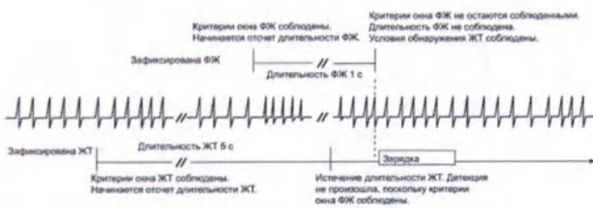
Рисунок 2-9. Взаимодействие таймеров длительности для желудочков, 2-зонная конфигурация, зарядка отложена
