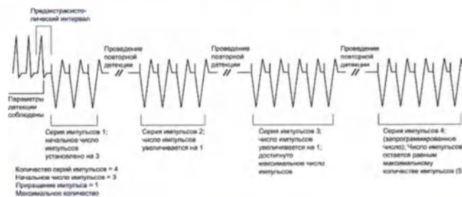
Рисунок 3–12. Взаимодействие максимального количества импульсов и количества серий импульсов
