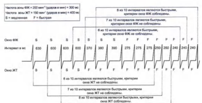
Рисунок 2-4. Взаимодействие окон желудочковой детекции, 2-зонная конфигурация
