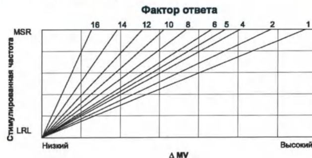
Рисунок 4–22. Связь между запрограммированной настройкой коэффициента ответа и ответом по частоте
