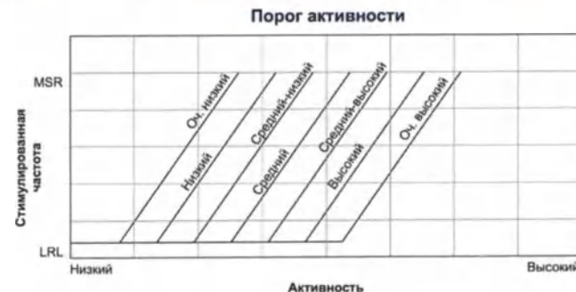
Рисунок 4–15. Порог активности и отклик частоты
