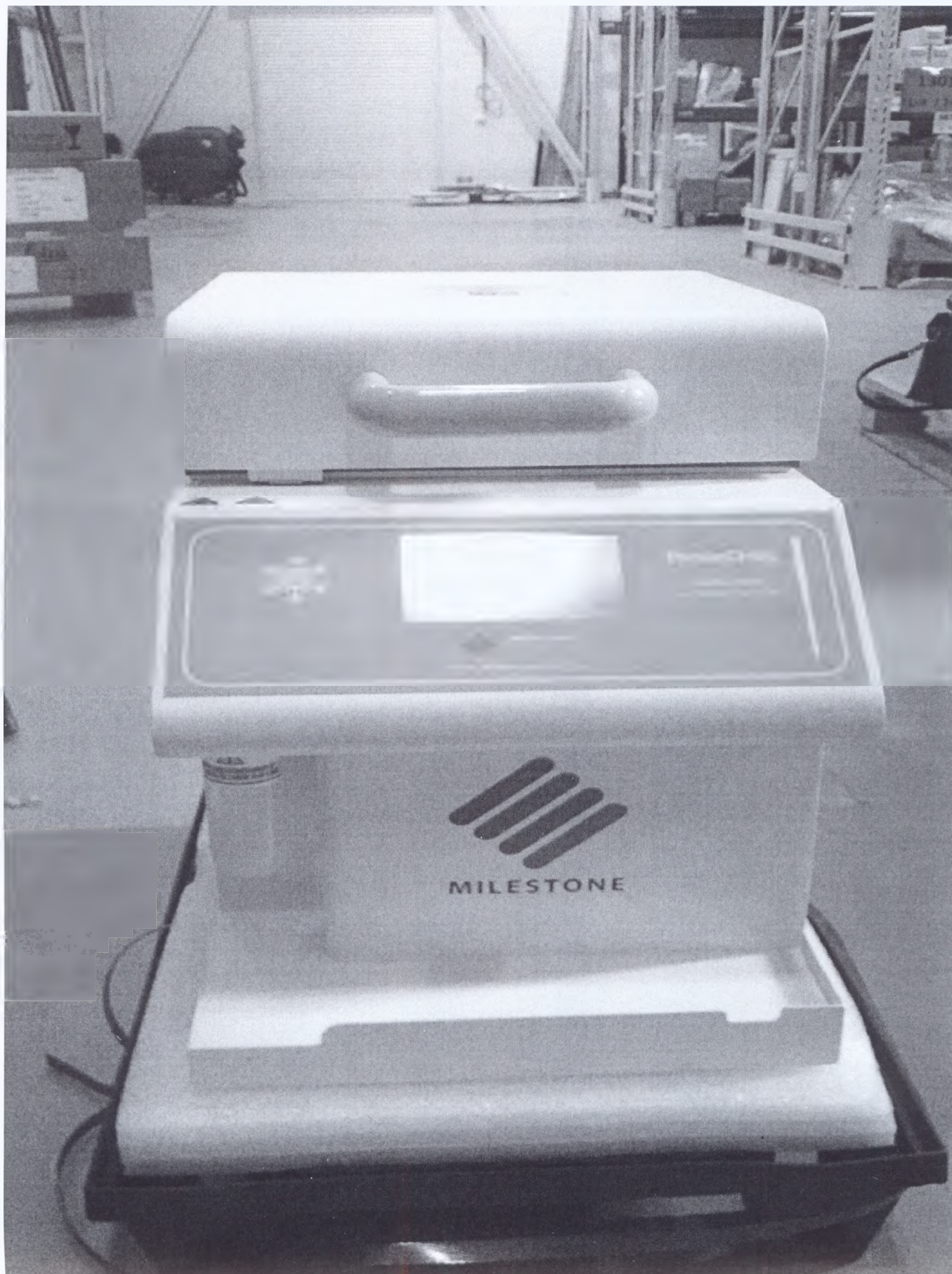
Рис. 1. Устройство для быстрой заморозки биологических образцов ПрестоЧИЛЛ (PrestoCHILL). Вид спереди.
