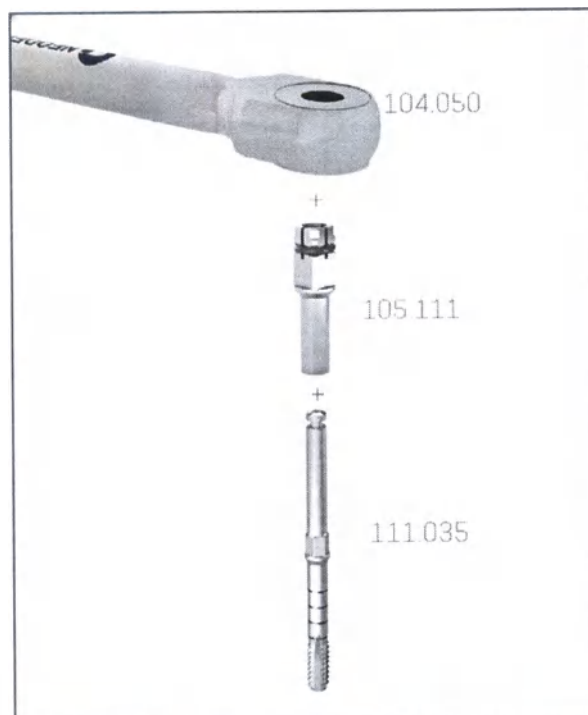
РИСУНОК 4. Выбор для формирования резьбы для Facility. Начинают с контругла и заканчивают ключом.
