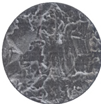
Пескоструйная обработка Sa= 0,67 мкм
