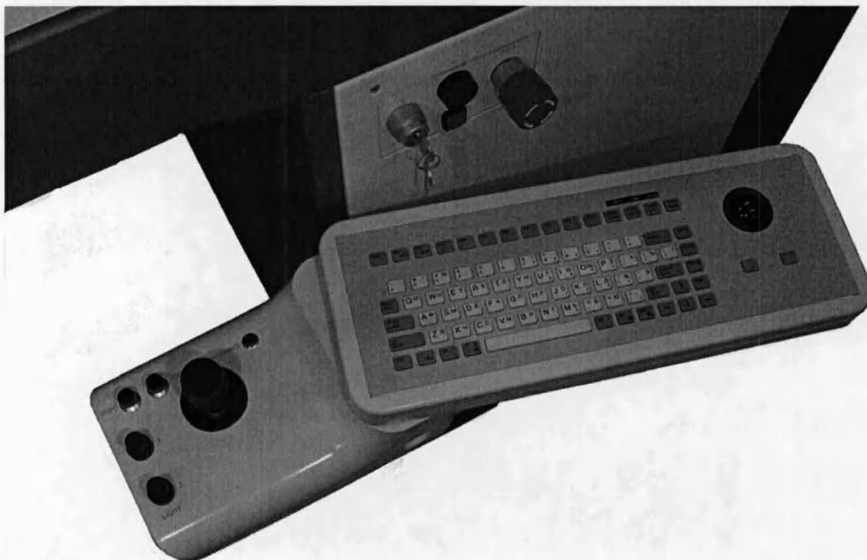
Рис. 2.6. Модуль управления системой.
