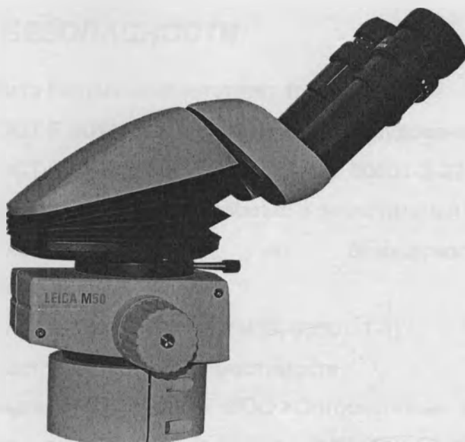
Рис. 2.21. Микроскоп оптический стереоскопический «Leica M50»
