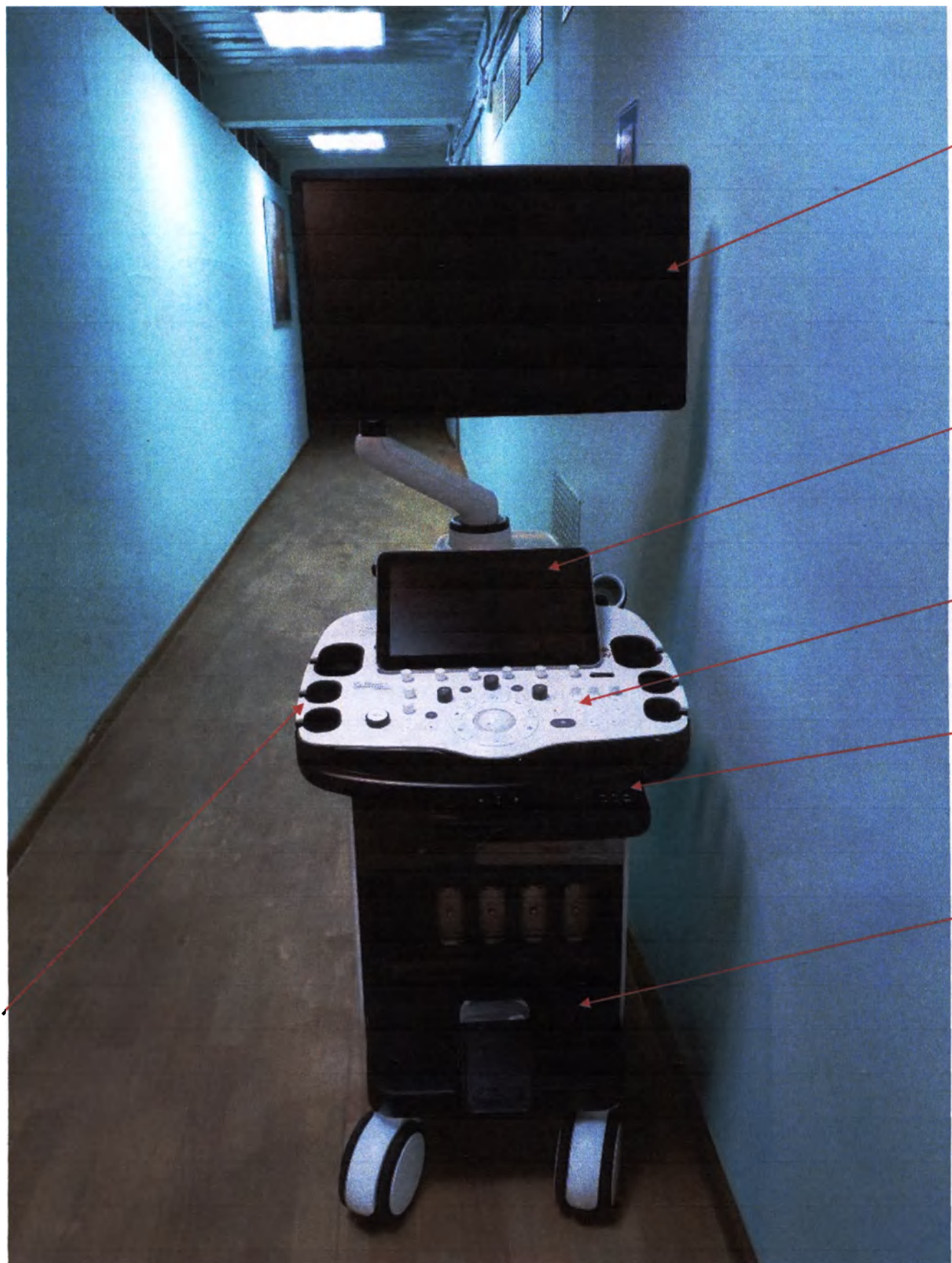
1. Консоль электронная, 2. Панель управления, 3. Специальный LED монитор, 4. Панель сенсорная, 5. Держатель датчиков, 6. Клавиатура.
