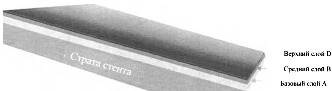
Рисунок: Схема слоев покрытия стента TETRILIMUS
