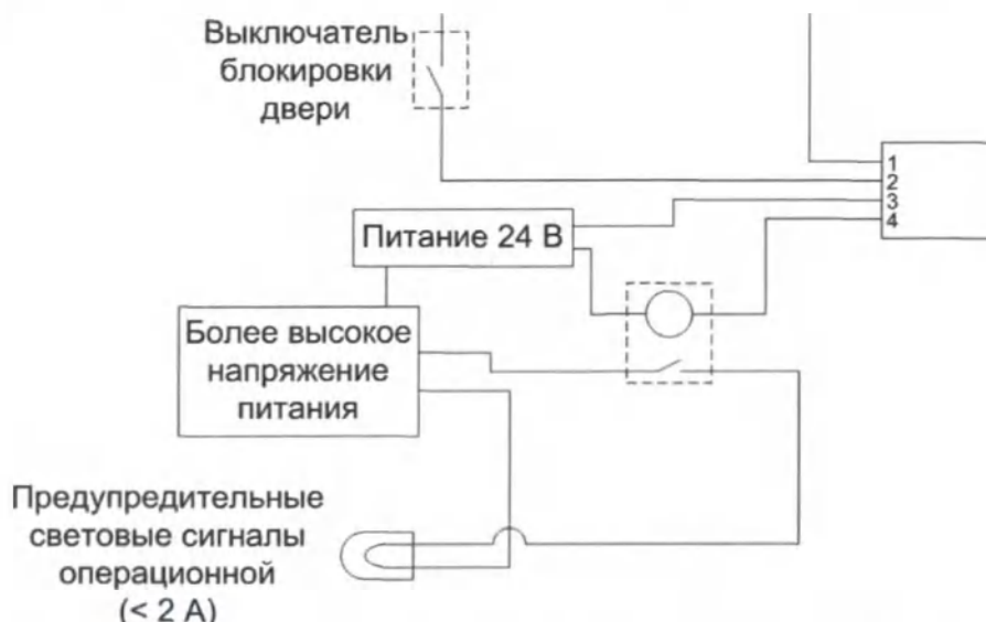
рис. 6.3. Электрическая схема для системы блокировки входа в операционную при использовании реле с сухими контактами.
