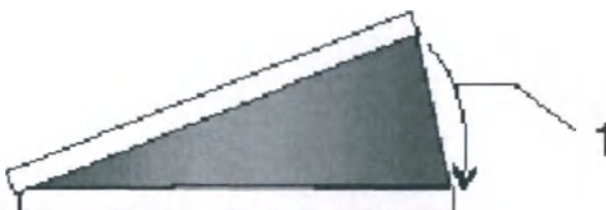
рис. 4.1. Вертикальное управление с одной областью, фиксированная скорость резки, линейный вакуум.
