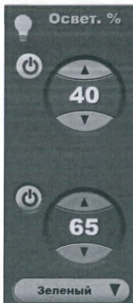
рис. 4.8. Элемент управления освещением: зеленое кольцо вокруг кнопки «Вкл./Выкл.» указывает на включение нижнего порта освещения (справа).
