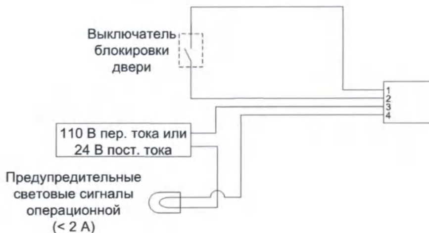
рис. 6.2. Электрическая схема для системы блокировки входа в операционную.
