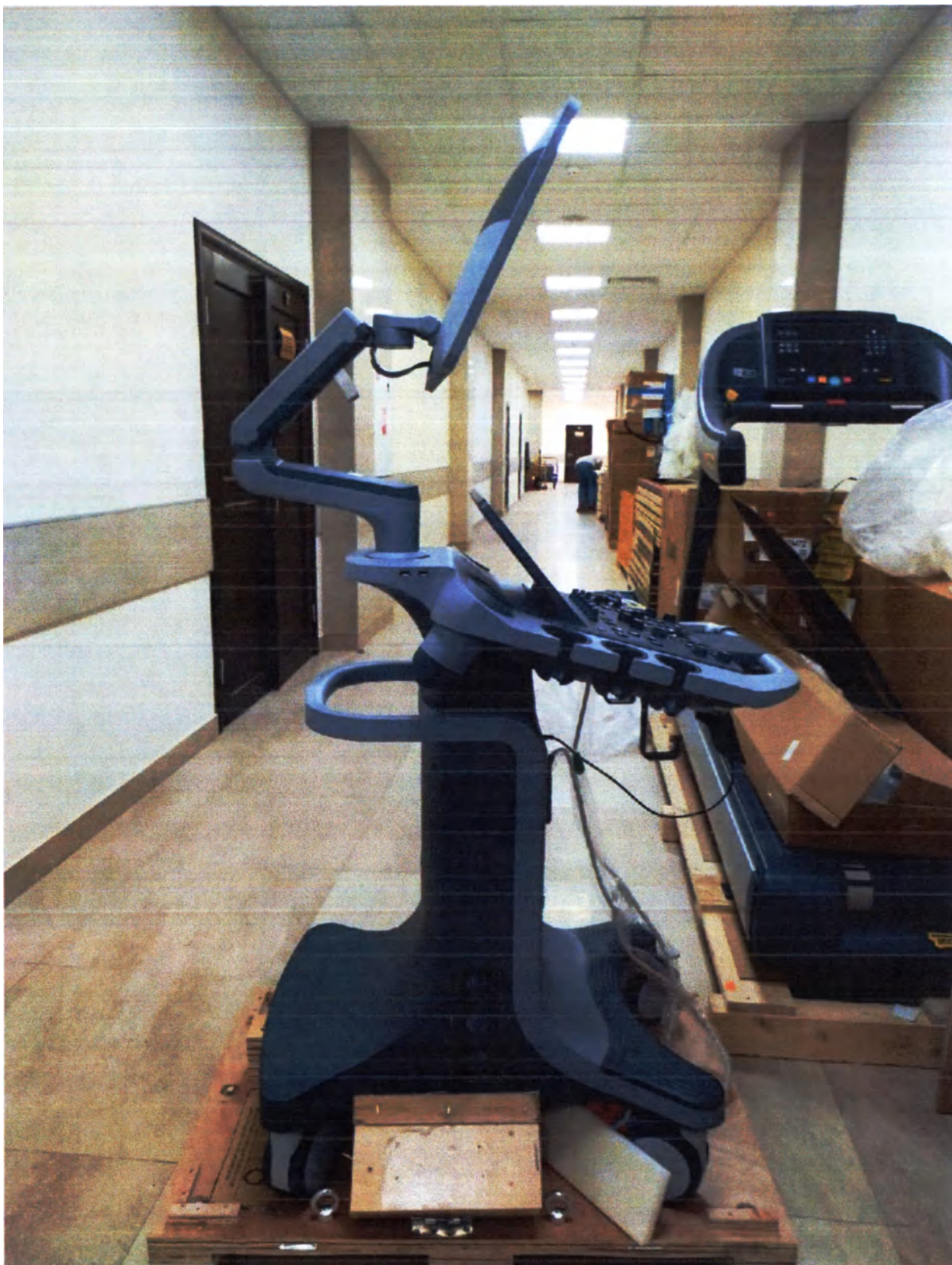
Внешний вид системы ультразвуковой AcclariX LX9 Super (вид слева) с подключённым внешним ЭКГ модулем и датчиком ультразвуковым
