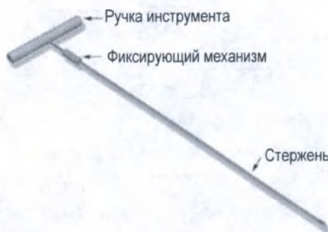
Рисунок 8. Инструмент для туннелизации в сборке
