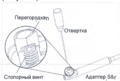
Рисунок 1. Местоположение стопорного винта в адаптере Precision S8
