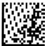
Рис. 2.4. Пример матричного кода GS1 DataMatrix
