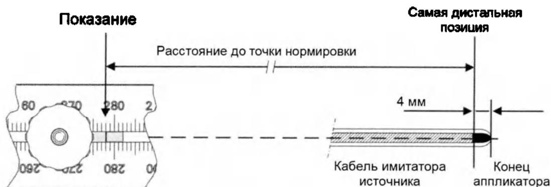
Рис.13: считывание значения расстояния до точки нормировки
