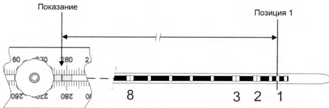
Рис. 23: определение позиций остановки источника, начиная с позиции 1
