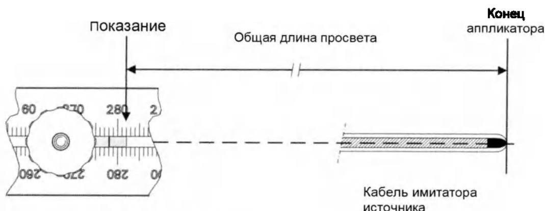
Рис.15: определение общей длины просвета
