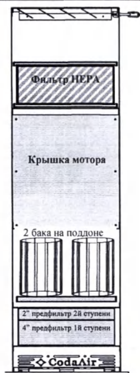
Схема установки фильтров в корпусе изделия
