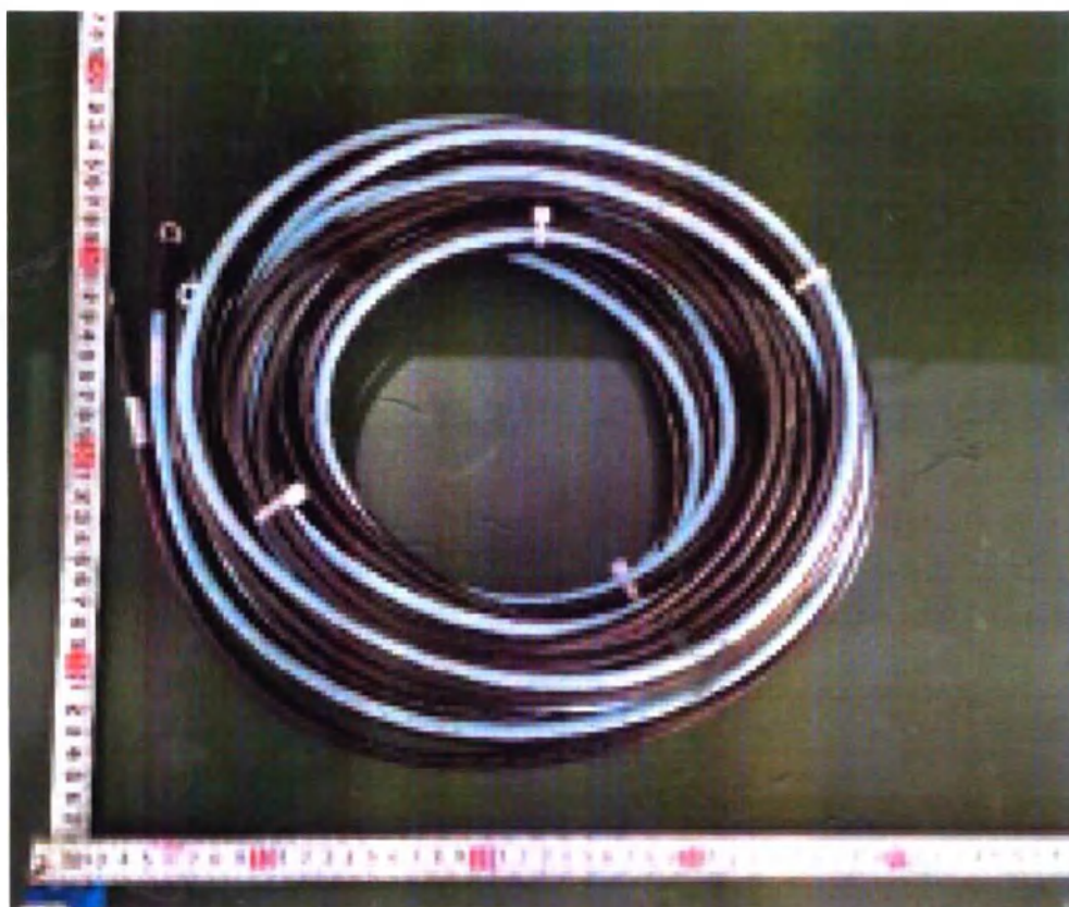
Фото 21 Кабель управления от передней нижней части Гентри к столу пациента
