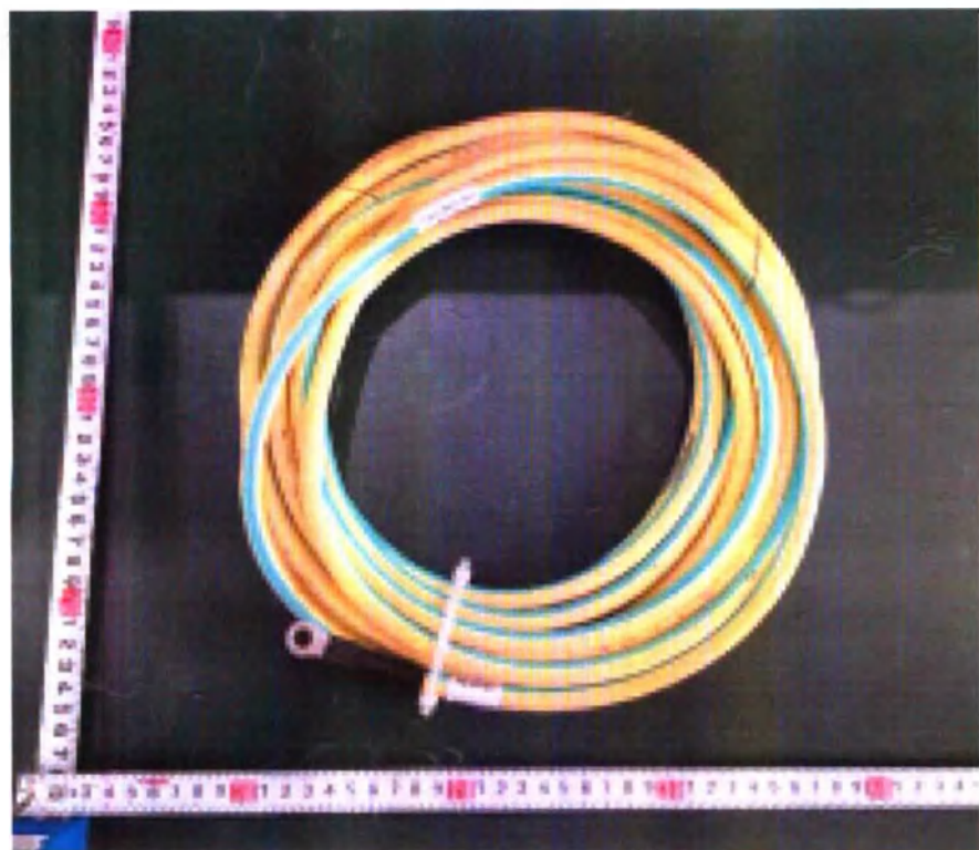
Фото 19 Кабель заземления от передней нижней части Гентри к столу пациента
