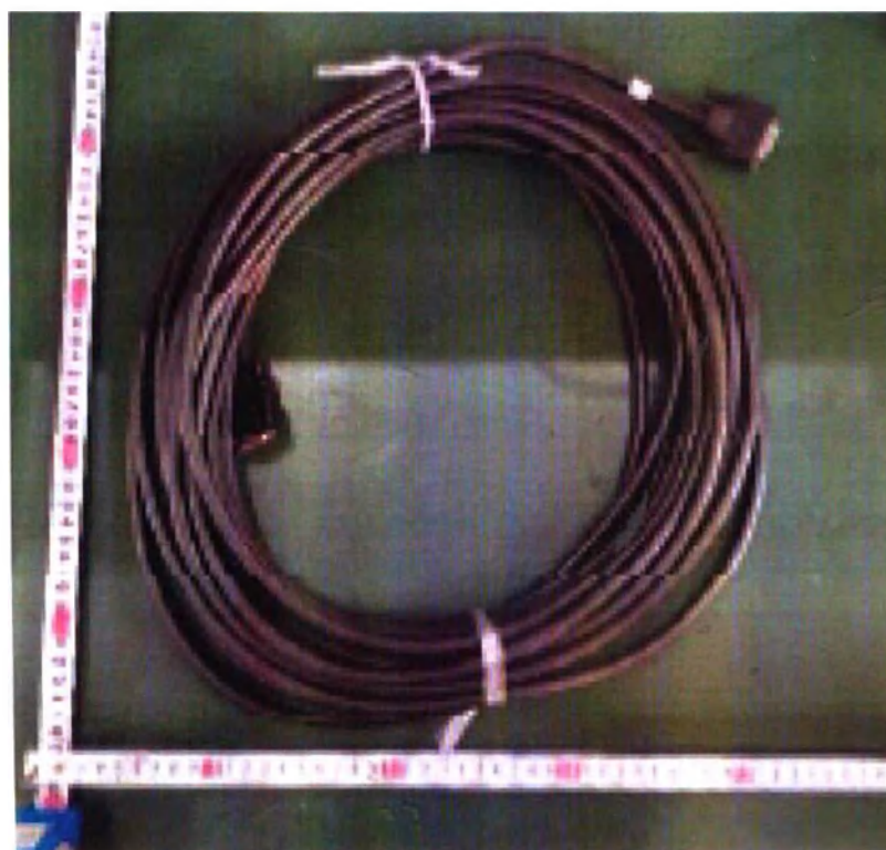
Фото 17 Жгут кабельный от консоли оператора к Гентри
