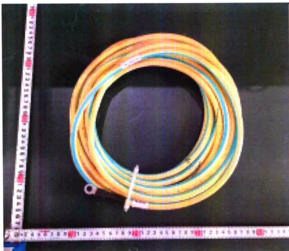
Фото 11 Провод защитного заземления от блока питания к Гентри
