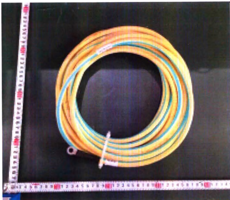
Фото 12 Провод защитного заземления от блока питания к консоли оператора
