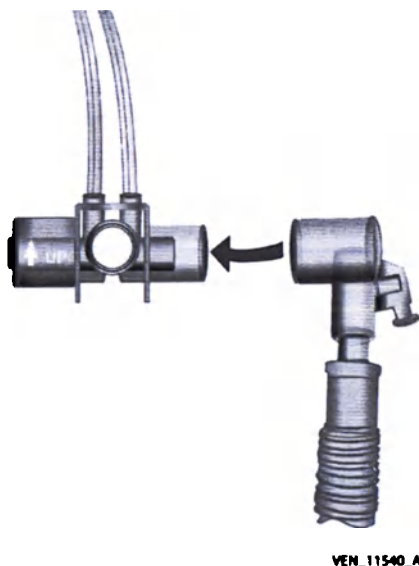
Рисунок 1-5. Подсоединение датчика поток/CO 2 и адаптера для воздуховода к тройнику дыхательного контура
