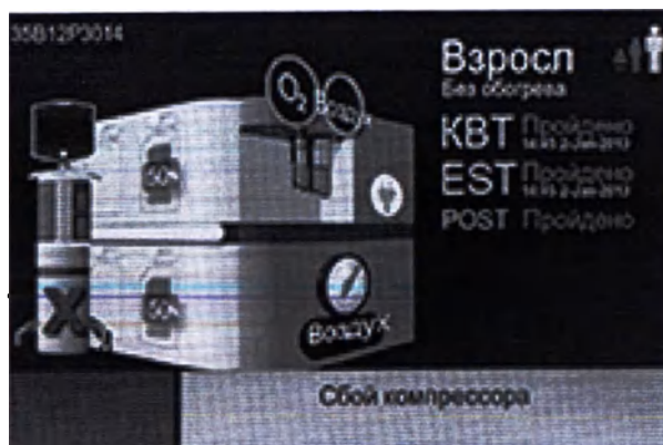
Рисунок 1-2. Дисплей состояния компрессора — сбой в работе компрессора
