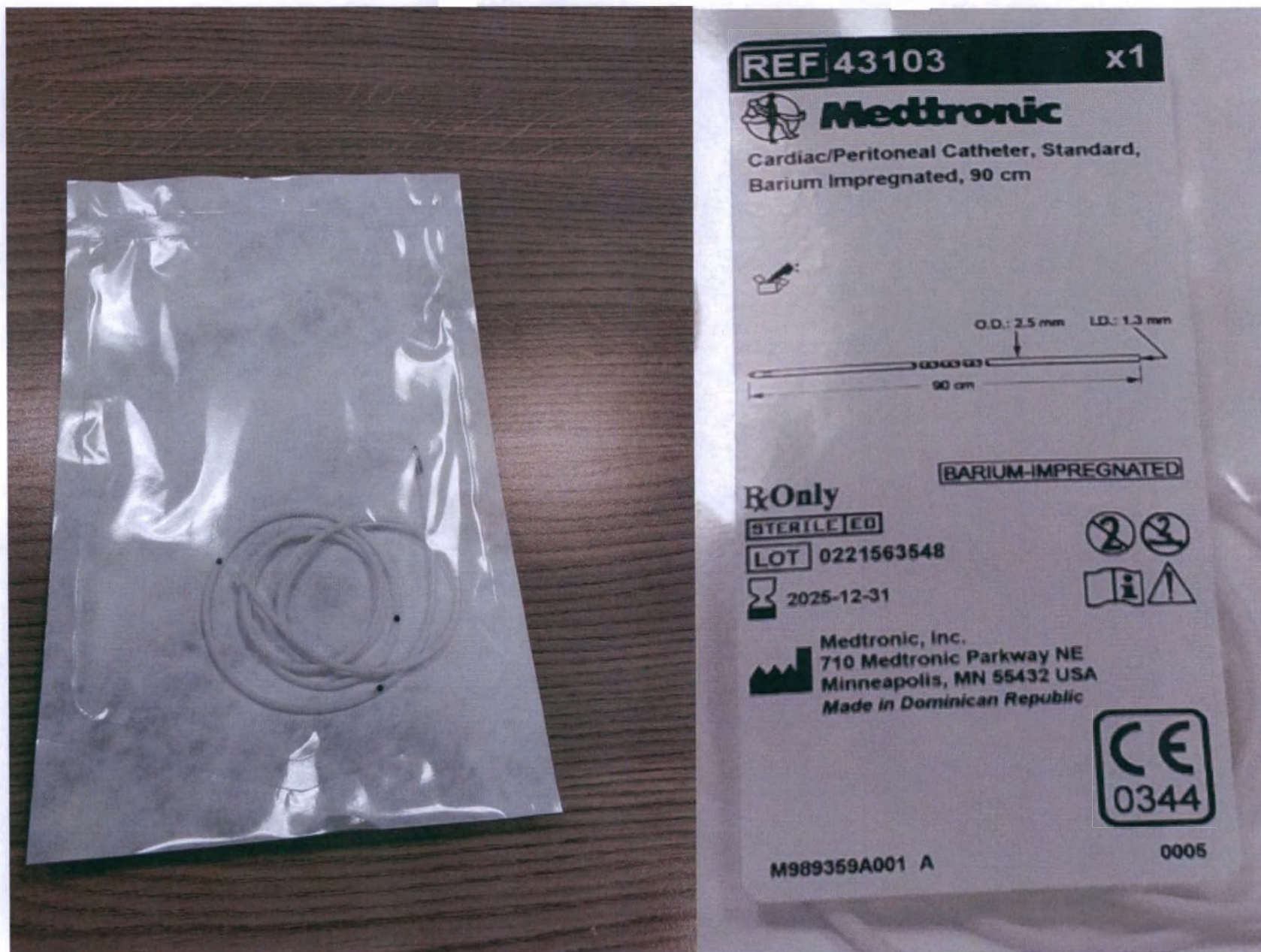
Фото 208. Кардио-перитонеальный катетер стандартный, импрегнирован барием, длина 90 см, наружный диаметр 2,5 мм (пункт II,11), первичная упаковка, маркировка первичной упаковки
