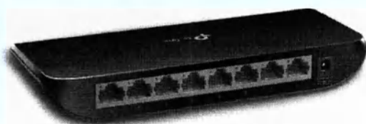
Компьютерный сетевой коммутатор (TL-SG1008D)
