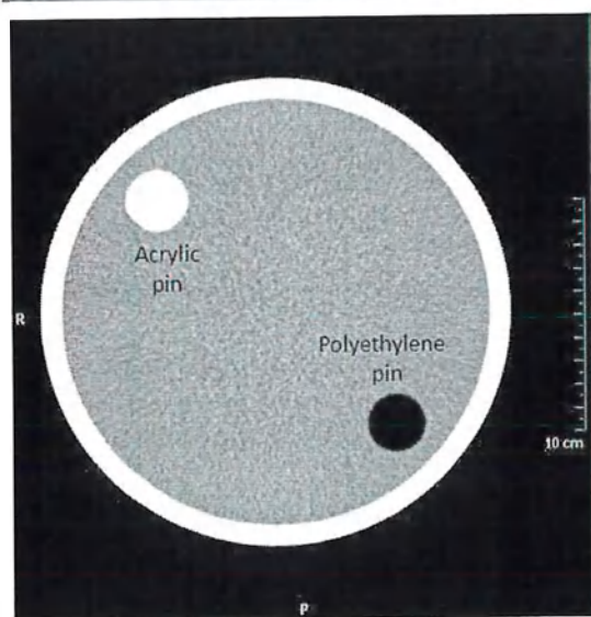
Проверка качества аксиальных двухмерных изображений головы
