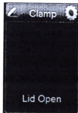
Рис. 22 - Вид панели при открытой крышке (венозный окклюдер)
