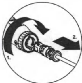
Рис.5. Вращение фиксирующего кольца влево и вытягивание
