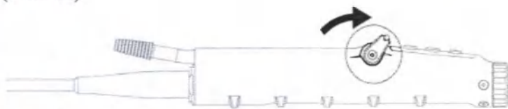
Рис 13. Аспирационный рычаг в открытом положении
