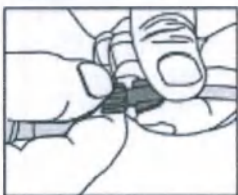
Рис 16. Снятие переходной трубки
