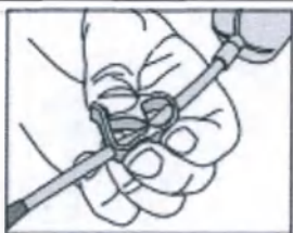
Рис 9. Открытие зажима под напорной камерой
