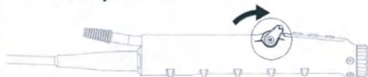
Рис 11. Аспирационный рычаг в открытом положении
