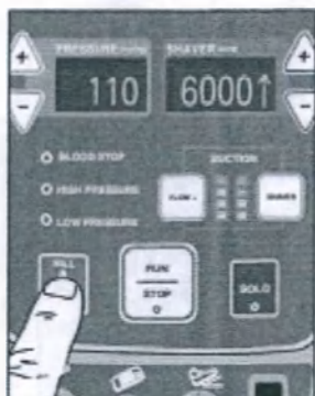
Рис 7. Нажатие кнопки НАПОЛНЕНИЯ камеры для заполнения насоса
