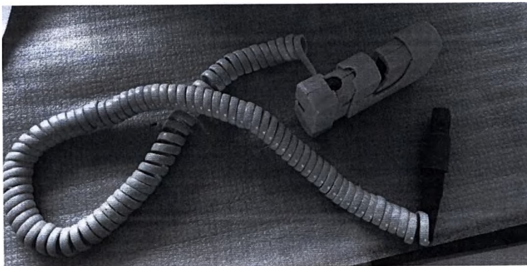
Рисунок В.2– Фотографическое изображение принадлежности для насоса в варианте исполнения ПА111: Датчик падения капель А) Вид сверху; Б) Общий вид
