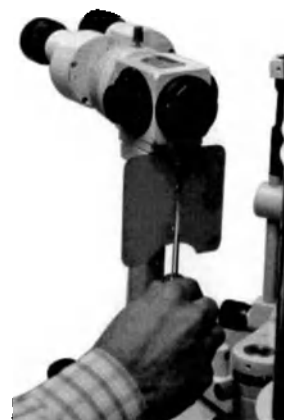
Этап 12: Прикрепить защитный экран на прихвате микроскопа
