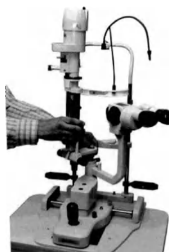
Этап 10: Ослабить стопорный винт, а затем вставить блок осветителя в стойку основания. Проверить плавность вращения блока и его фиксацию.
