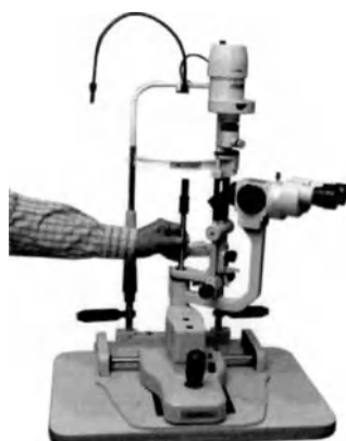
Этап 11: Закрепить стержень для фокусировки в отверстии, предусмотренном в стойке основания
