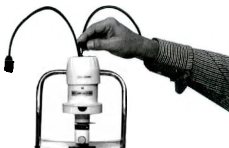
Этап 11: Закрепить стержень для фокусировки в отверстии, предусмотренном в стойке основания
