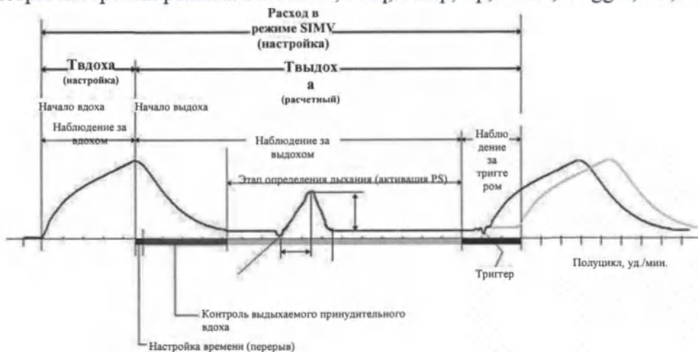
Рисунок 9-5 График сигнала в режиме SIMV
