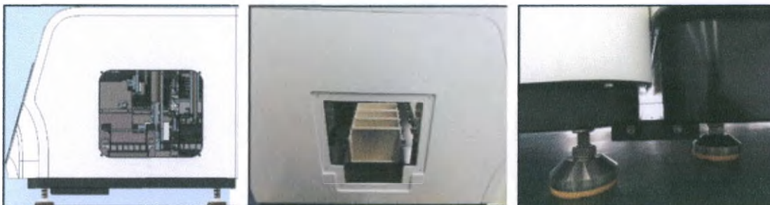
Рисунок 52. а) Панель для онлайн-режима б) Трансферная панель аппарата для окрашивания на стыковочной поверхности в) Стыковка аппарата для заключения CS500 и аппарата для окрашивания DP360
