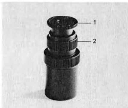
Рис. 49 Установочная трубка 1 Регулируемая глазная линза 2 Зажимное кольцо для фиксации положения фокусировки
