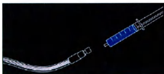
Рисунок 5-3. Заполнение шланга для увлажнения газа
