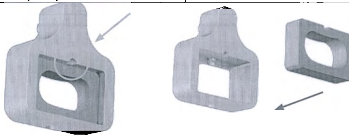
Рис.14 Подготовка калькара / Fig.14 Calcar preparation
