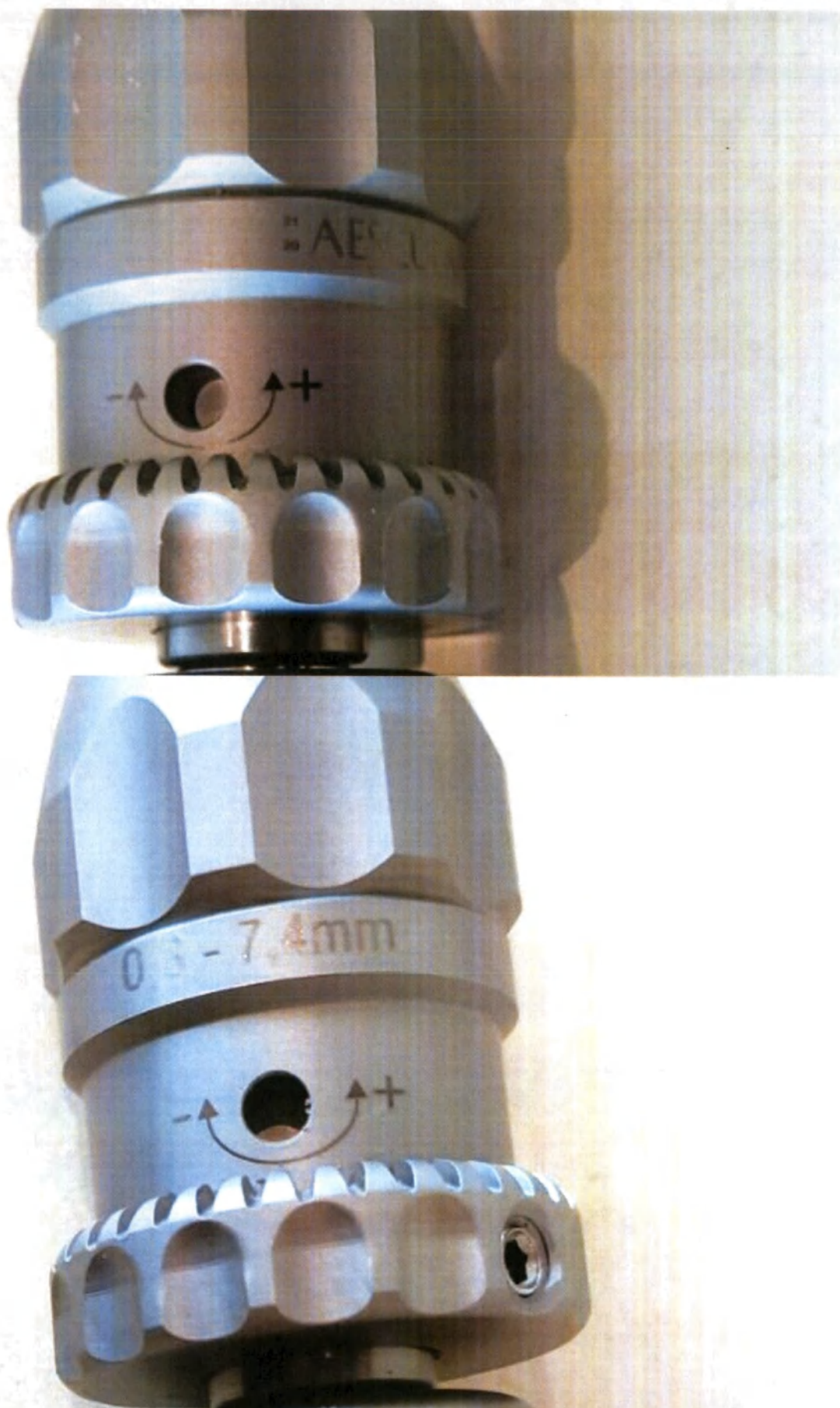
Насадка-дрель, тип Jacobs большой зажимной, на дрель/рипер хирургический Acculan 4: GB620R – маркировка непосредственно на изделии
