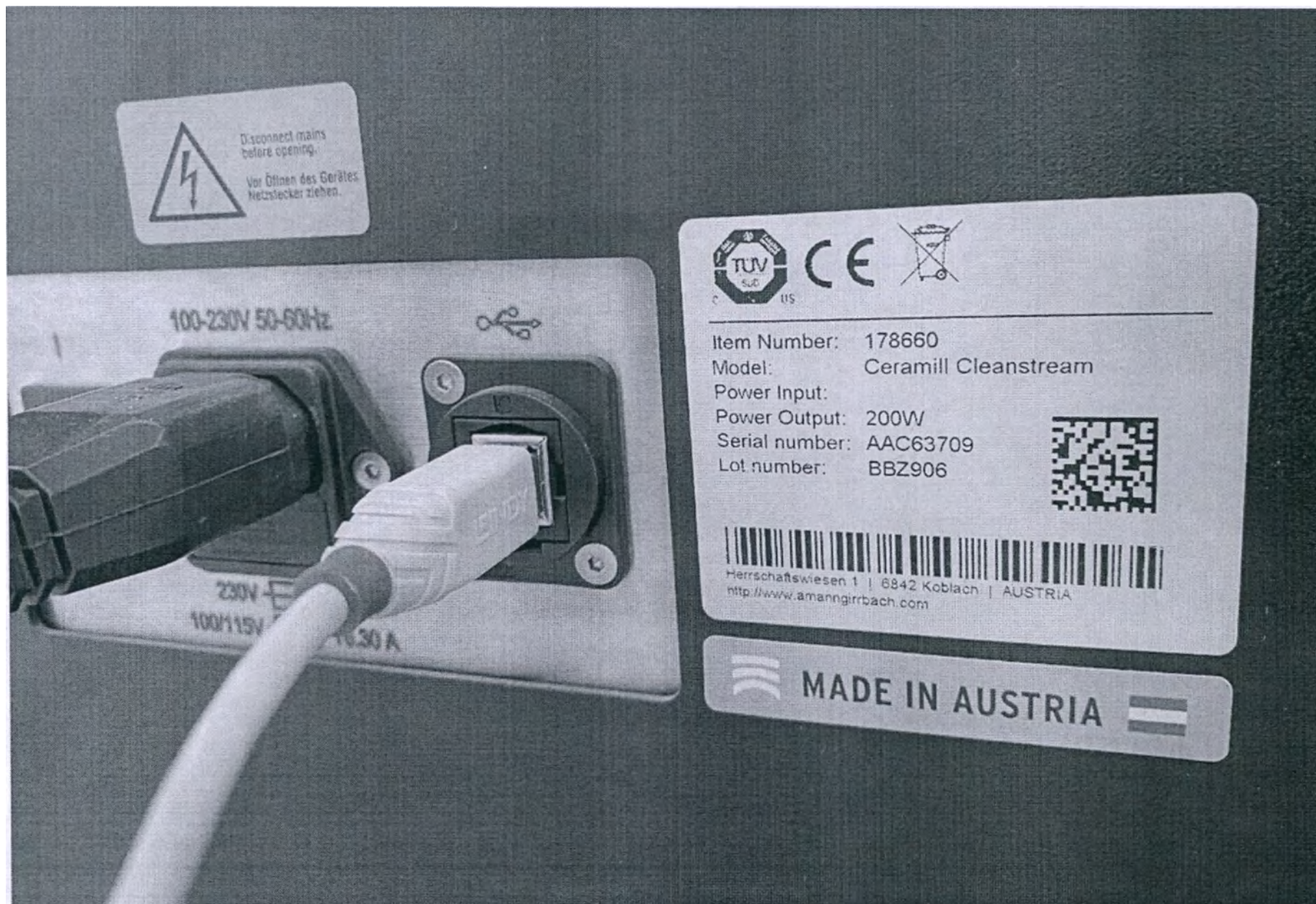
Система подачи смазочно-охлаждающей жидкости с интегрированной системой удаления стружки Ceramill Cleanstream. Заводская табличка
