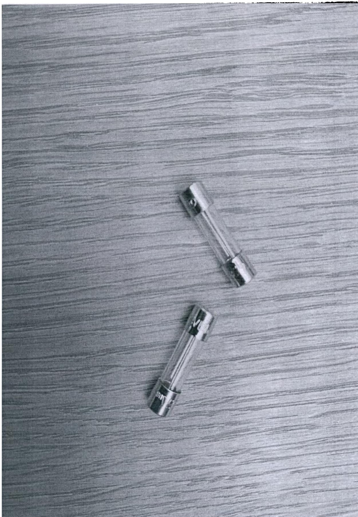
Предохранитель Т 3,15 А Предохранитель Т 6,3 А
