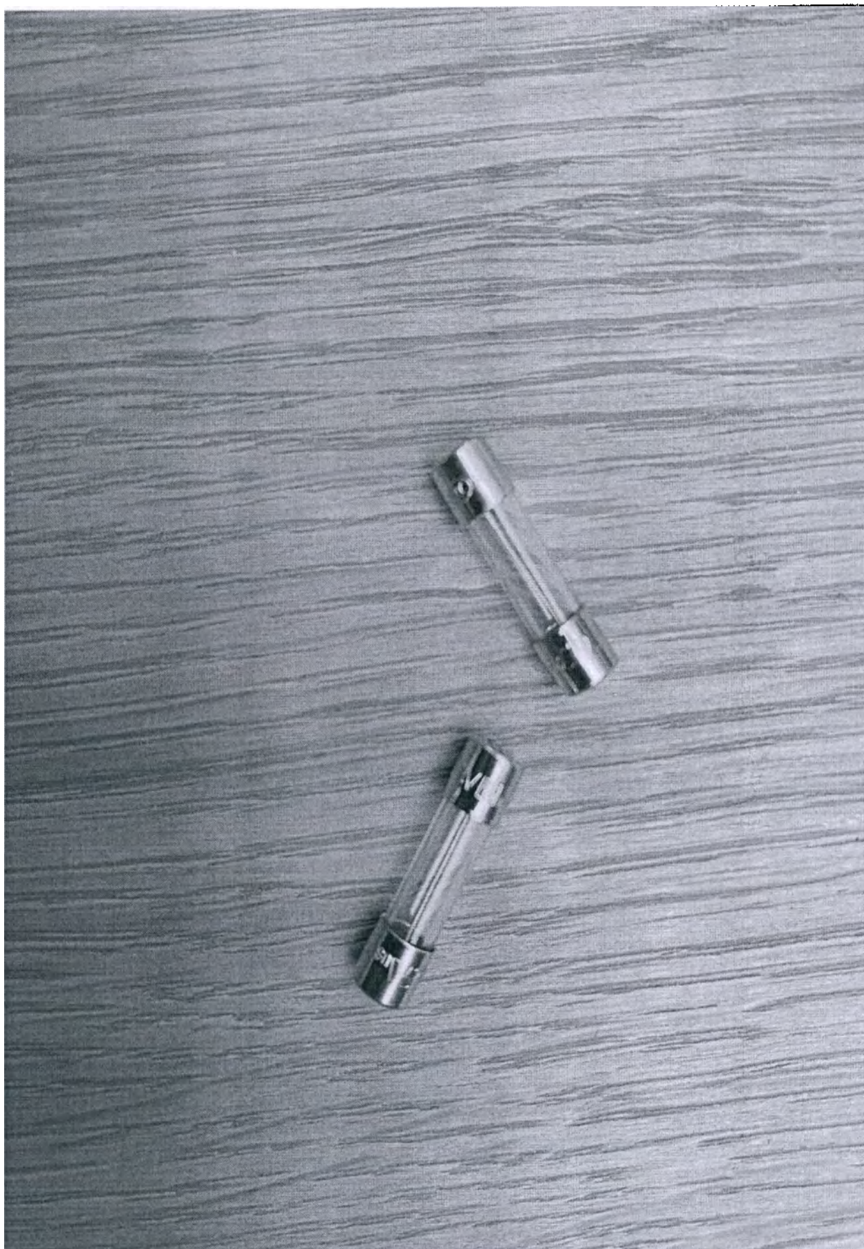
Предохранитель Т 3,15 А Предохранитель Т 6,3 А
