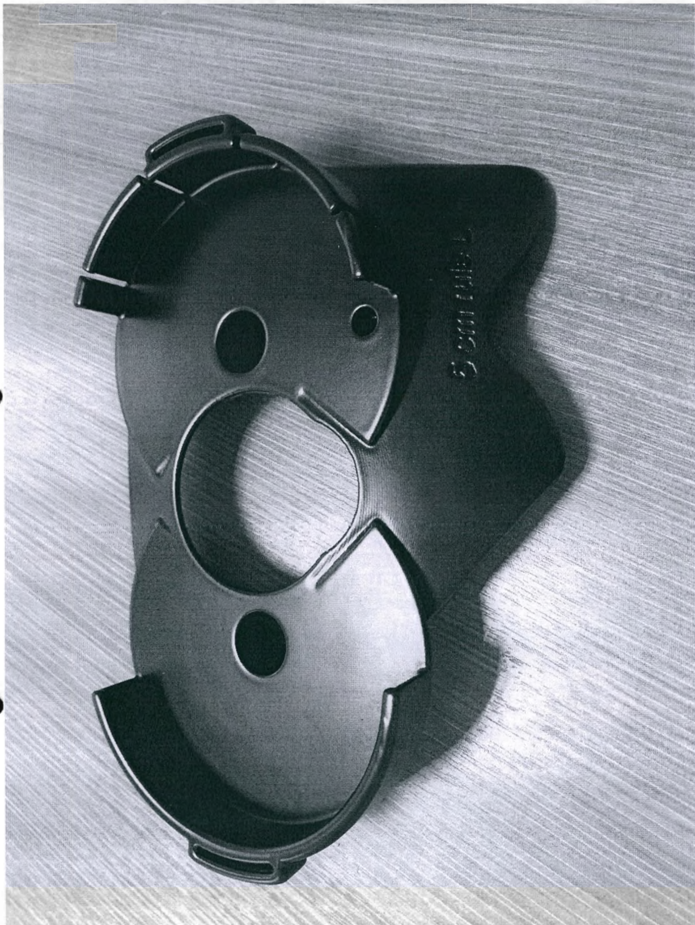
Разметочная пластинка для индуктора 8-образного с охлаждением.
