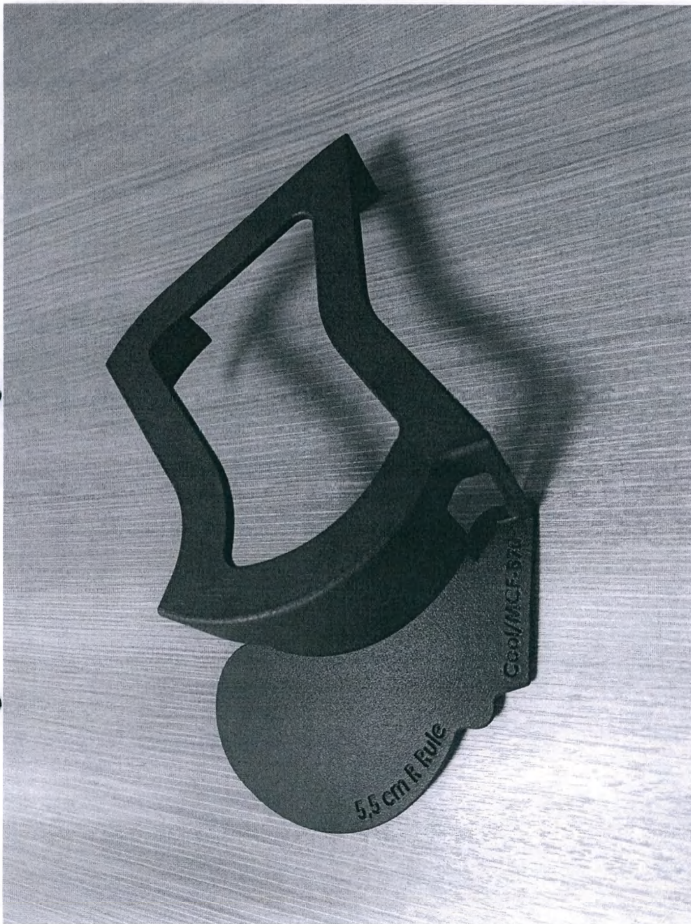
Разметочная пластинка для индуктора 8-образного изогнутого с охлаждением
