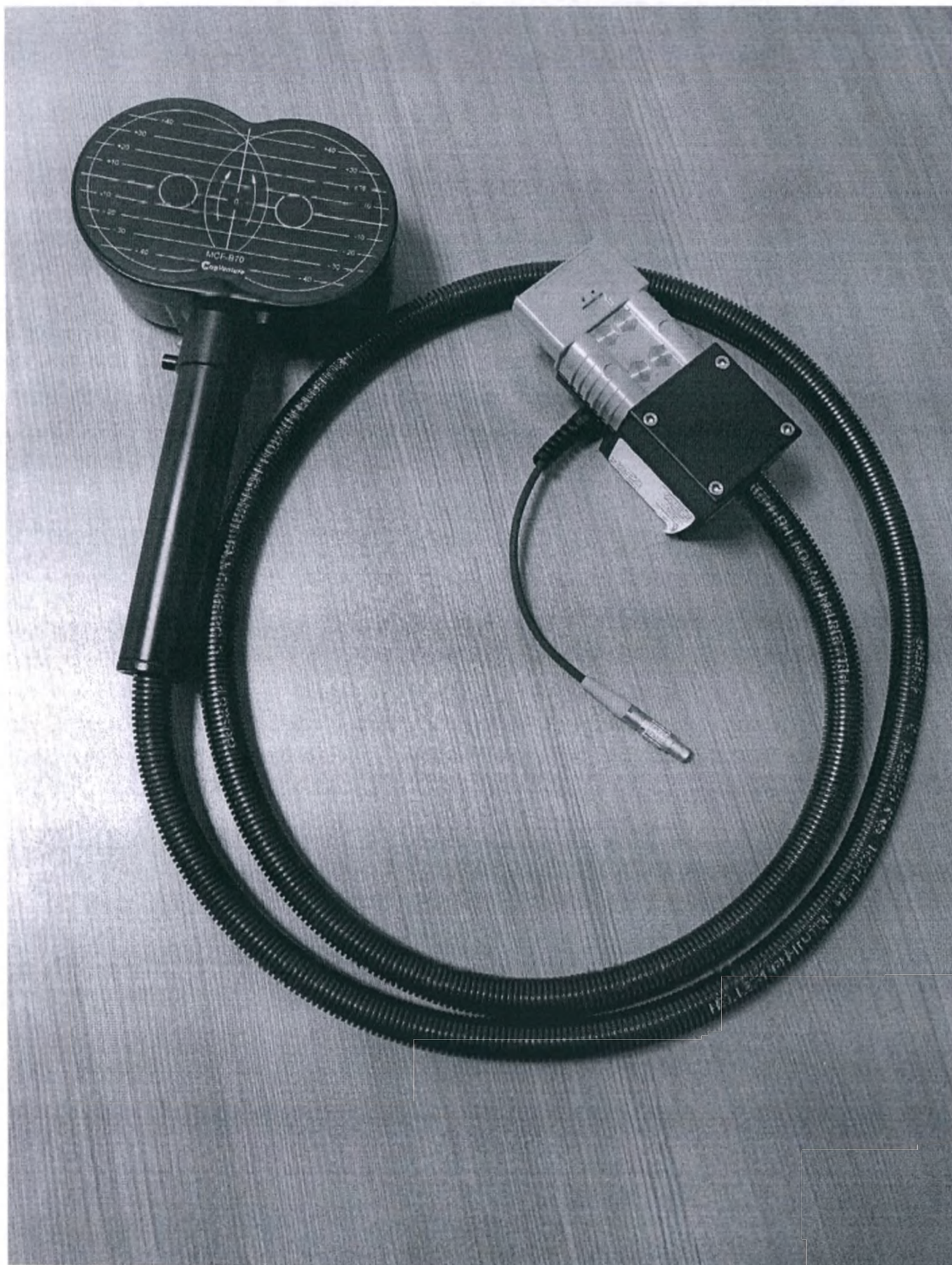
16. Индуктор 8-образный изогнутый со статическим водяным охлаждением:
