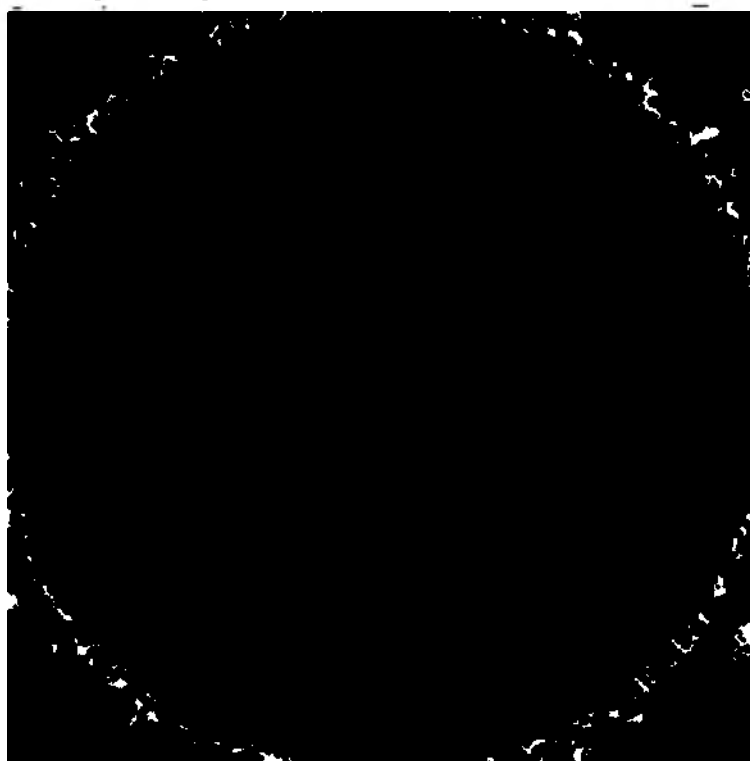
Рисунок 14.3 –Рентгенограмма круглого фантома (правильное значение H_Offset)
