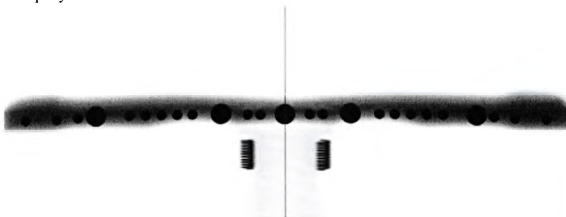
Рисунок 14.5. Правильное положение фантома-шарика.
