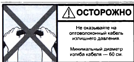
Рисунок 2.14 Предупредительный знак по обращению с оптоволоконным кабелем
