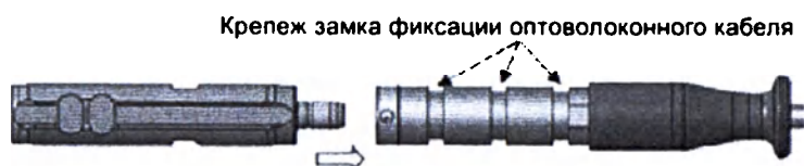
Рисунок 4.9 Картридж и крепеж оптоволоконного кабеля
