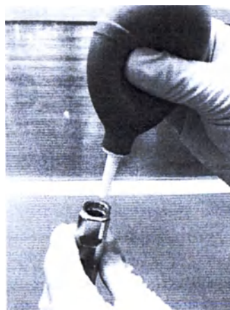
Рисунок 6.4 Удаление посторонних частиц с линзы картриджа
