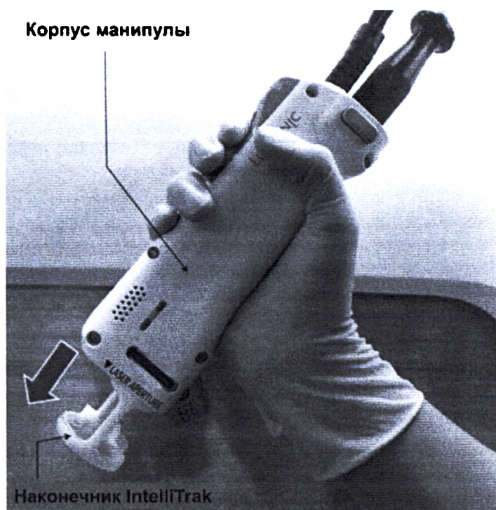
Рисунок 6.9 Отсоединение корпуса манипулы и наконечника
