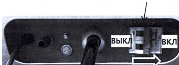
Рисунок 4.21 Подсоединение основного питания
