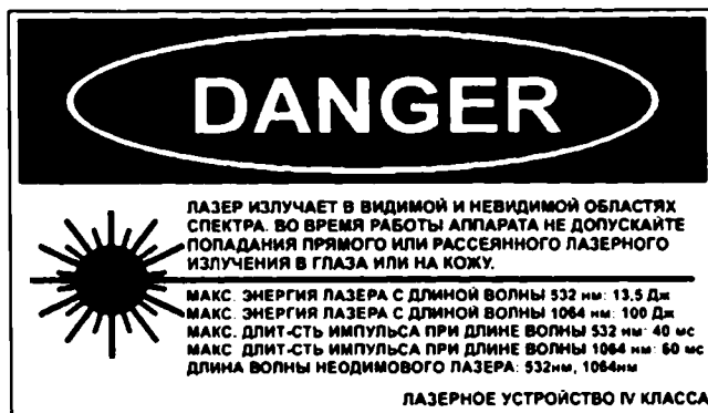
Рисунок 2.16 Предупредительная табличка о выходном излучении лазера
