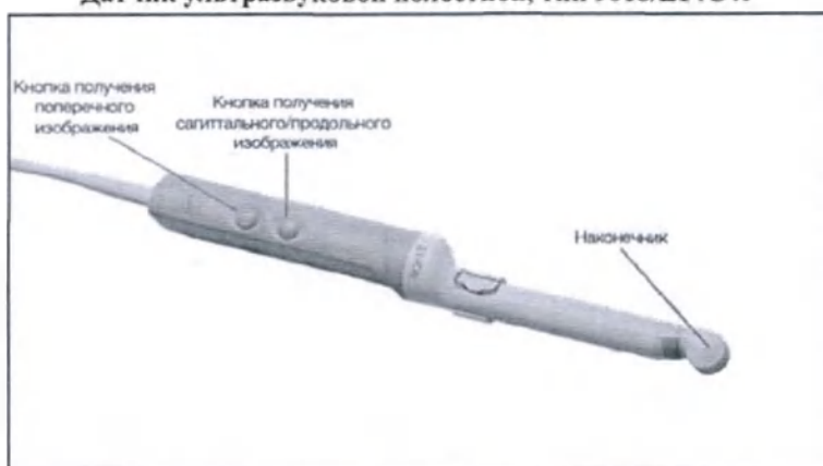
Датчик ультразвуковой полостной, тип 9018/E14C4t
