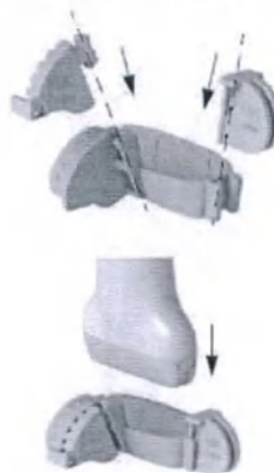
Пункционный адаптер UA1338 для датчика 9032
