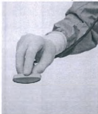
Удержание датчика 9016 при сканировании.
