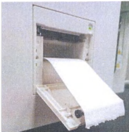
Рисунок 2-9 Установка бумаги для термопечати (2)
