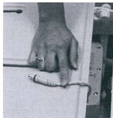
Рисунок 5 – Отсоединение кабеля батареи от блока управления
