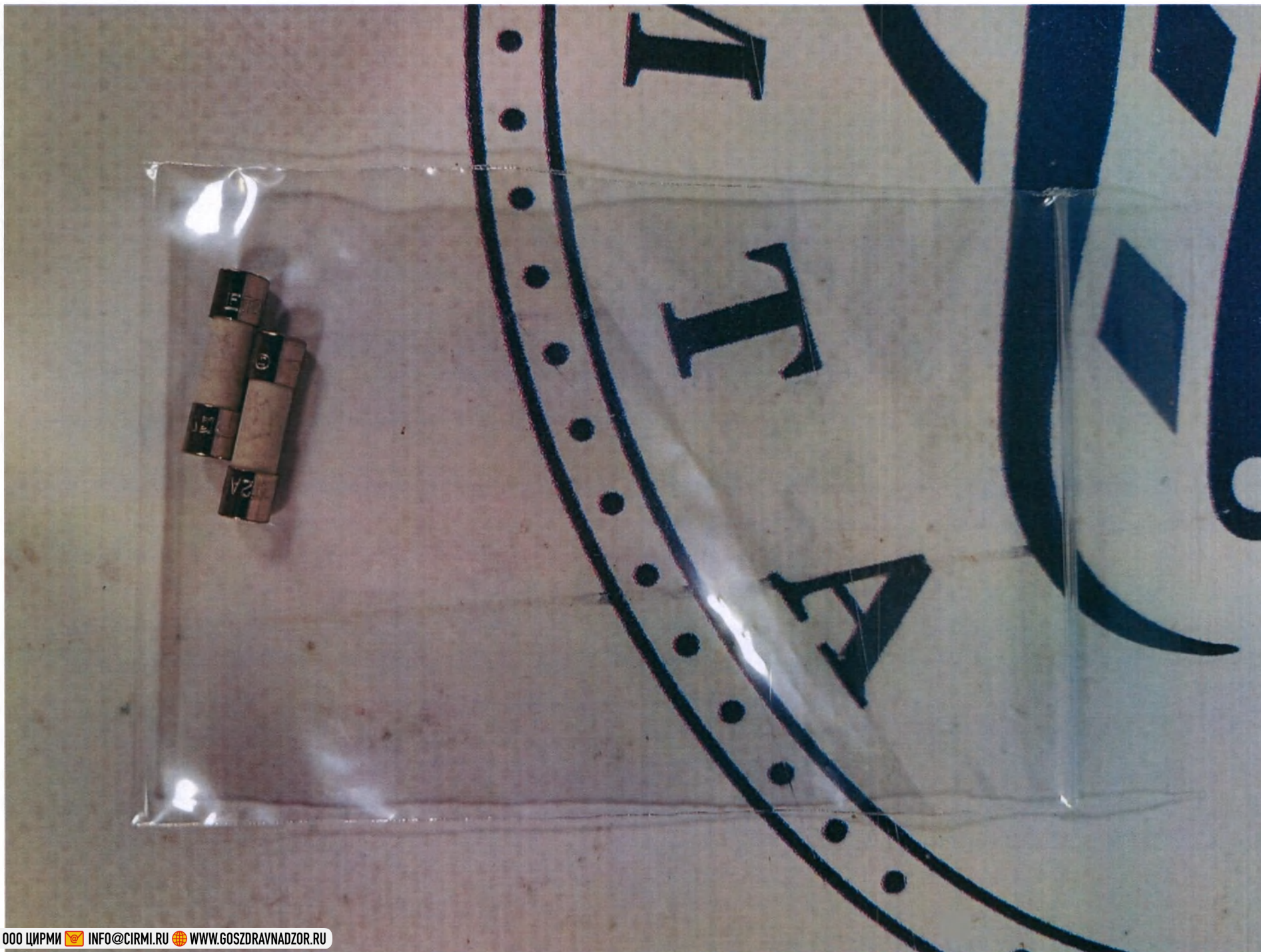
4. Плавкий инерционный предохранитель, 250 В, 2.0 А, \varnothing 5.2 \times 20 мм
