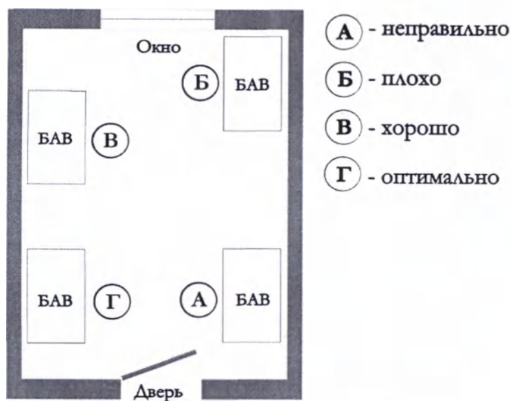
Рисунок 4 — Место установки бокса
